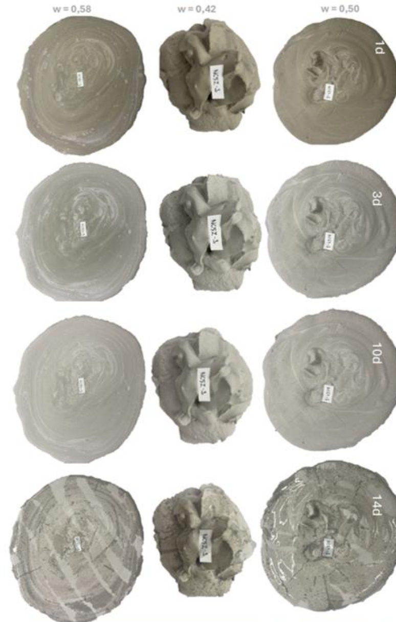
Cement byl při homogenizaci dobře zpracovatelný. 1d, 2d: vše bez trhlin. 3d: w=0,58 2 vlasové trhliny, do 14d zaceleny, zůstala 1 vlasová u w=0,5, po smočení plošně nasávkavé kraje jen w=0,58 i křehké, celkově: 2
